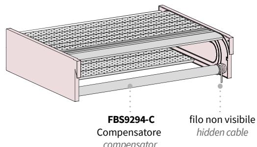
**N.B.** Per i Kit con doghe wind microforate viene usato il compensatore FBS 9294-C
